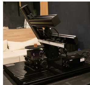
多品種製造に対応可能な外観検査機
