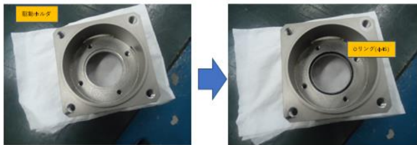
駆動ホルダOリング溝に、グリスを薄く塗ったOリングを入れる (Oリングφ45)
