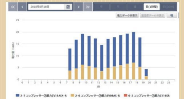
3台あるコンプレッサのうち2台を通常時に使用し、流量不足時や専用の工作機械を使用する場合に3台目を稼働していた。FEMSを導入しエア流量と電力を測定し分析することにより、通常時に稼働させる2台の組み合わせの最適化をおこなった。稼働状況にもよるが8%~16%の電力削減となった。
