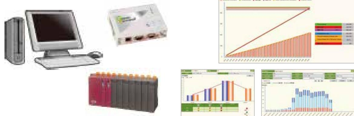
FEMS/BEMSの基本はまずデータの「見える化」から始まります。エネルギーをマネジメントするために、必要なデータを計測・蓄積し、運用者に適切な行動を促す基盤となります。たとえばFEMSの場合は、対象はユーティリティから生産設備、共通部門全般に渡り、電力、熱(冷熱、温熱)、エア等のみならず、工場の生産情報や気象情報等まで一元的に管理することでより効果的な仕組みの構築可能となります。この仕組みを実現する上での最大のポイントは、最終的に工場全体のエネルギーを最適化するために必要最低限の計測ポイントに絞り込んで、まず整備していくことにあります。特に電力系は比較的容易に計測システムを構築可能ですが、熱系(冷水、温水、蒸気等)の計測は時間もコストもかかるため、最適な計測ポイントの設計が必要となります。計測データは、出来るだけ運用者に見やすく表示し、時系列でのエネルギー使用実績は元より、カテゴリー別内訳(工場別、建屋別、工程別等)や過去との比較、更には生産実績と連携することで原単位管理を行うことが可能となります。
