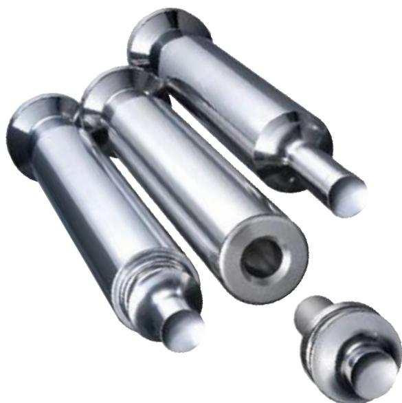
「杵」とは、薬や健康食品などの「錠剤」を作る際に使用する打錠成型用金型のこと。「錠剤」を作る打錠機は、粉末状の薬剤の入った「臼」を、「杵」と呼ばれる部品が上と下から加圧して錠剤の形状をつくる仕組みとなっている。
