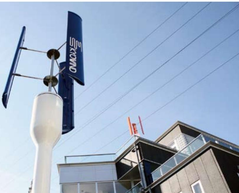
効率的な発電と風きり音の抑制を実現した、垂直軸直線翼型風力発電機。風を受けるブレード（翼）を均一に同心円状に配置することで、どの方向の風も途切れることなく捕捉し効率良く発電。また、ブレードを同心円状で旋回させることで、プロペラ型の風車でしばしば問題となる騒音や低周波振動の原因とされる風切り音の発生を抑えることに成功。3枚翼のコンパクトタイプと、5枚翼のミドルタイプとがある。
