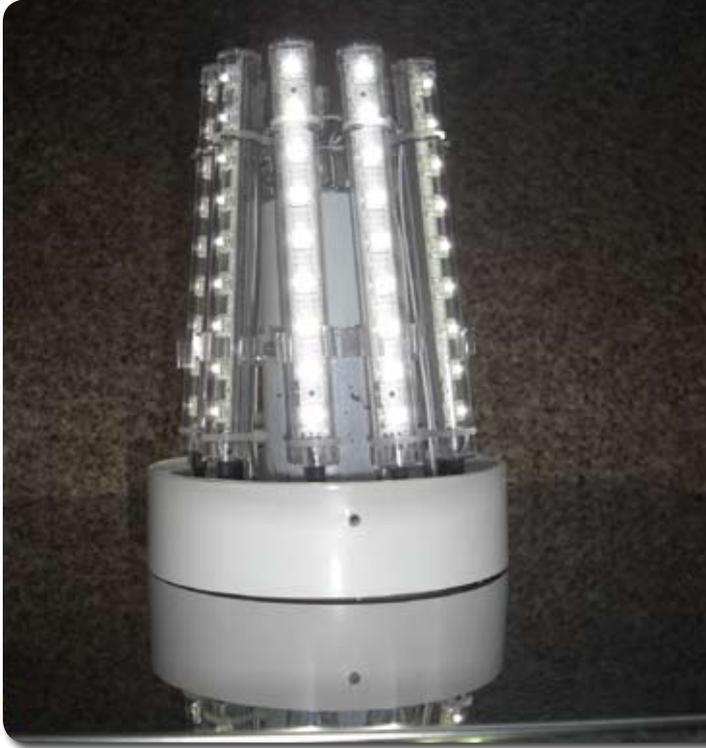
省電力かつ寿命の長いLEDを使い、棒状モジュールの配置を工夫して作成した円筒形の照明。あらゆる方向に対する照度を保つことができるため、街灯として利用可能。また、組み立てが簡単なので教材として利用することができ、地域密着型・教育的効果も期待できる。
