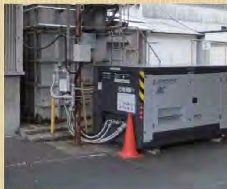
・北越工業 エンジンコンプレッサー PDS390SC-501 1台 ・空気量 11.0 m 3 /min 吐出圧力 0.69Mpa ・水冷ディーゼルエンジン ターボチャージ2999cc 出力84.4kw/2200rpm
