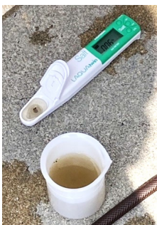
図5 間隙水の塩分濃度測定(海水の30~66倍に希釈された)
